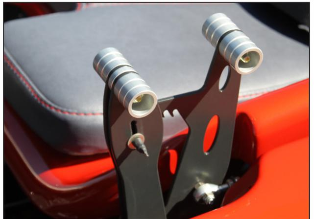
油门和刹车手柄位于驾驶舱左侧，符合飞行员使用习惯
