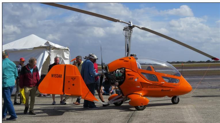
SilverLight 公司的 AR1“游侠”自转旋翼机具有可拆卸的整体整流罩, 可以很方便地在封闭座舱和敞开式座舱之间转换
