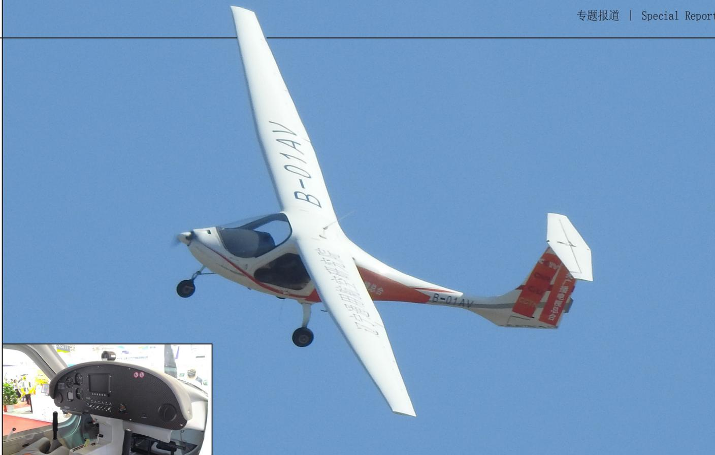
锐翔 RX1E-A 电动轻型飞机增程改型在珠海进行了精彩的飞行表演。该机起飞全重提高到 600 公斤，装有 28 千瓦时电池，采用 50 千瓦电动机，最长持续时间 2 小时。
