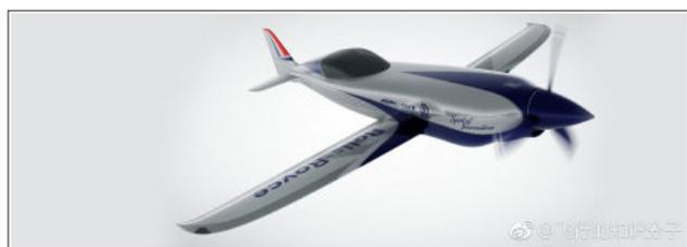
罗罗公司在研制一款全电动竞速飞机，设计时速超过 300 英里 / 小时（约 482 公里 / 小时），有望打破全球电动飞机目前的速度记录，目前的记录是西门子基于 Extra 特技机改制的电动飞机，2017 年创造的 210 英里 / 小时（约 338 公里 / 小时）的速度记录。罗罗计划 2020 年进行试飞，将作为“加速飞行电动化”（Accelerating the Electrification of Flight, ACCEL）项目的一部分。该机电机由 YASA 公司提供，该机采用三台大功率电机串列布局，总功率 700 千瓦。
