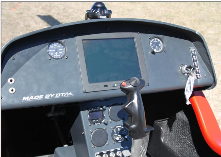
Kanardia 公司提供的 N ésis 综合显示器,采用 8.5 英寸大屏,能够显示飞行、导航、发动机等多种信息
