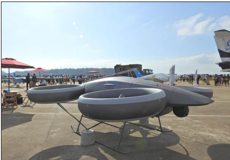
中航工业制造的大型多旋翼垂直起降无人机，使用独特的内燃机和传动系统来驱动固定螺距螺旋桨。
