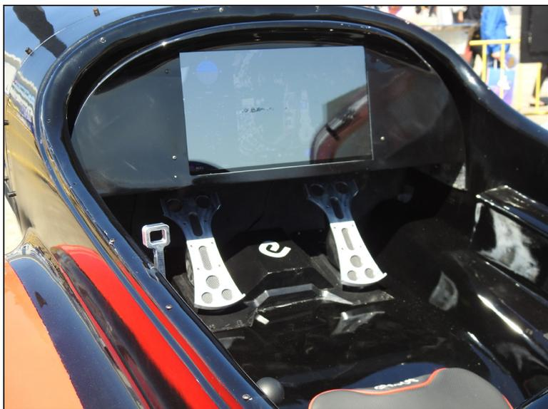
亿航改装的 MX 特技机座舱。注意看改装的方向舵脚踏。操纵杆被右扶手上的小操纵侧杆取代。方向舵踏板和操纵杆都没有与控制面直接机械连接，它们只是将输入信号发送到飞控计算机。根据亿航介绍，该机采用四台独立的飞控计算机以实现安全冗余。
