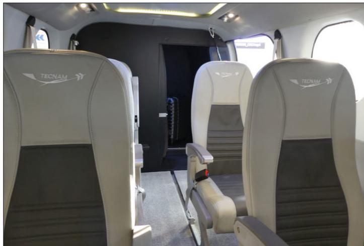
座舱内景，后部的行李舱与座舱联通，可以在飞行中打开
