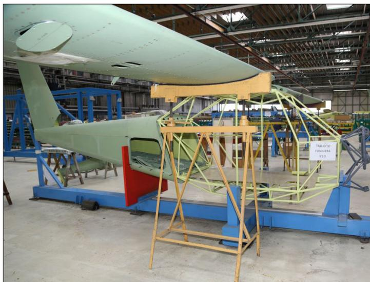
该机的特点是前机身采用钢管焊接骨架，以此连接机翼、发动机与后机身，这种结构简单可靠，强度较大
