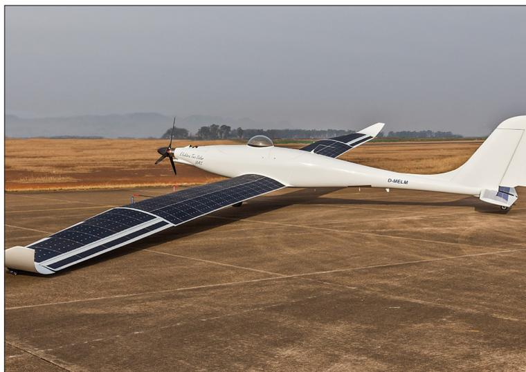
Elektra Solar GmbH 公司的电动飞机目前正在使用锂离子电池和太阳能。该公司首席执行官 Calin Gologan 表示：“我们相信，氢气作为混合解决方案对我们的机型来说非常重要，特别是在日照不充足的地区或季节。混合动力用锂电池（用于起飞阶段）和氢气（用于巡航）至少可以使飞机的续航时间和航程增加一倍。”
